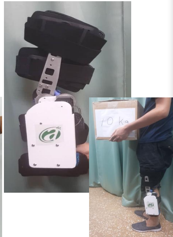
動力版膝關節輔具搬運測試
