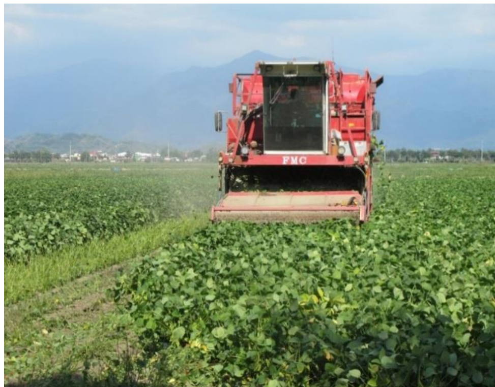
安裝GPS車載與影像監測系統之毛豆採收機於田間採收情形
